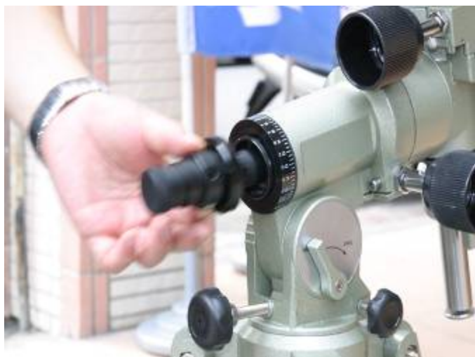
第九步驟：套上極軸望遠鏡後,再旋回去
