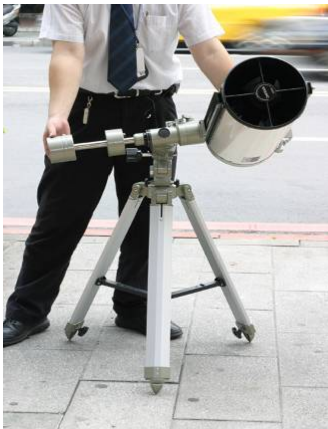
第十九步驟：左右轉動,看哪一邊重,調整重鎚位置,作平衡。
