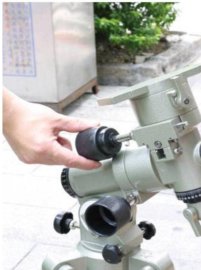
第十三步驟：試試赤緯鈕調整的手感
