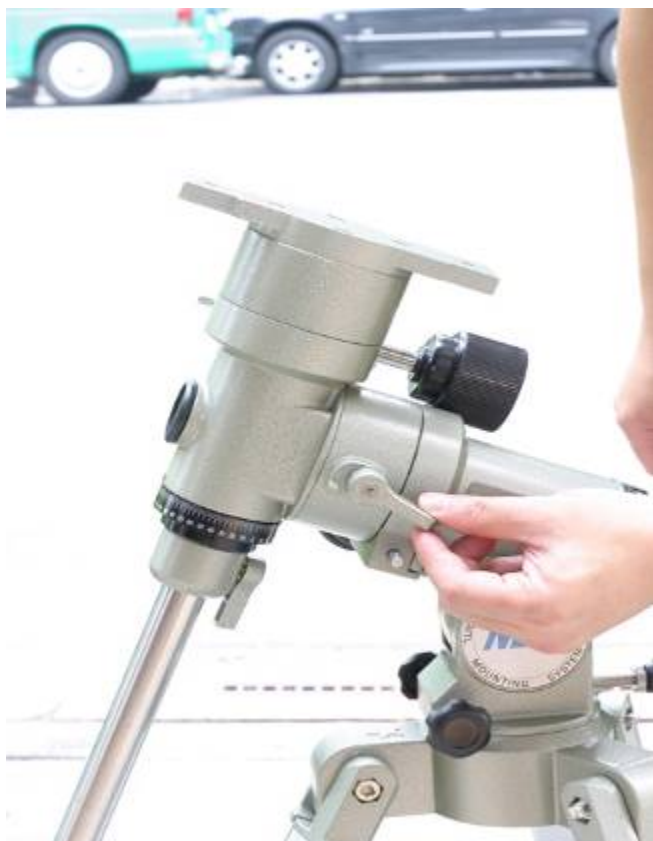
第十七步驟：但需先將 VC-200 主鏡筒裝在 NES 赤道儀雲台上,再作平衡動作。第一先鬆開赤經鈕。
