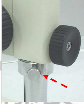
1.3.將限位套環緊貼於托架下方鎖緊
