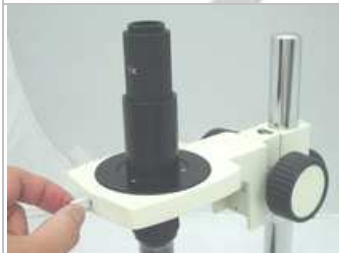
1.5.將顯微鏡本體置入托架中並鎖上
