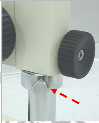
1.3.將限位套環緊貼於托架下方鎖緊
