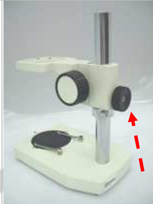
1.2.將托架置入,旋緊後方固定旋鈕
