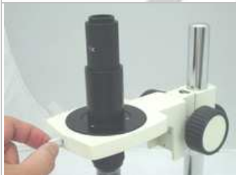
1.5.將顯微鏡本體置入托架中並鎖上
