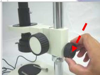
4.6 由於鏡頭與樣本之間需保持一定距離方能成像，若您一直對不到焦點，請藉由鬆開托架的固定螺絲，將托架提高或下降後，再重新對焦
